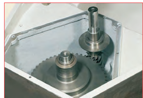
Nebenantrieb durch Schrägzahnräder im Ölbad
